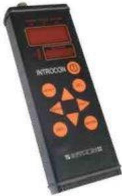
A unidade básica está conectada ao scanner com cabo até 8 m de comprimento. É alimentada por bateria e equipado com 2 displays. Os dados são armazenados nos dados incorporados e podem ser baixados após a inspeção usando o software Wintrocon ©, um poderoso instrumento para analisar dados e fazer o relatório de inspeção.
