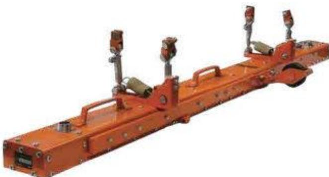
Princípio de operação INTROCON é baseado no método de corrente parasita (Eddy Current). O instrumento contém um scanner e uma unidade básica (BU).
