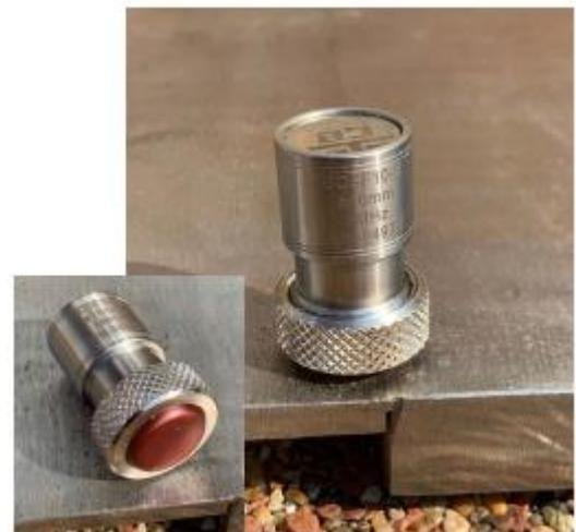
Os transdutores de inspeção são compatíveis com os detectores de falhas Proceq
